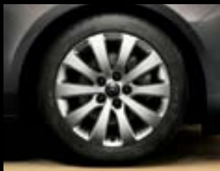
Jante din aliaj, 7 J x 17", design multi-spițe, pneuri 225/50 R17 (PGQ 2 ). Standard pentru nivelul de echipare Cosmo.
