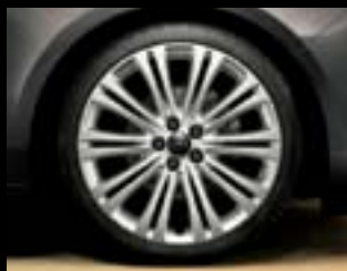
Jante din aliaj, 8 J x 19", design multi-spițe, pneuri 235/40 R19 (RV4 2 ).
