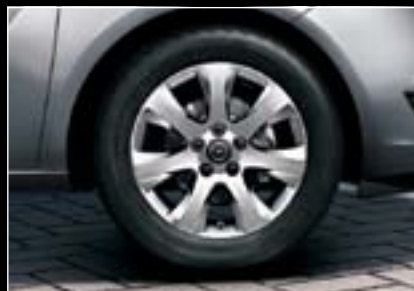
Jante din aliaj, 6.5 J x 16", cu 7 spițe, pneuri 205/55 R 16 (PWB). 4
