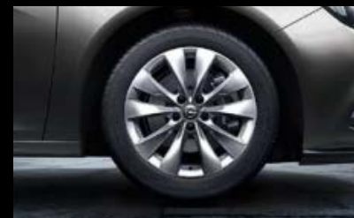
Jante din aliaj, 7,5J x 18", design cu spițe multiple, pneuri 235/50 R 18 (RQJ). 6
