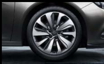
Jante din aliaj, 8J x 19", design cu spițe multiple bicolore, pneuri 235/45 R 19 (RVB). 5
