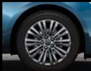
Jante din aliaj, 7 J x 17", design cu 10 spițe duble, finisaj Titan lucios, pneuri 215 (225)/50 R 17 (PWW). 10
