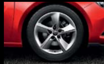
Jante din aliaj, 7.5 J x 18", 5 spițe, pneuri 235/50 R 18 (RSZ 4 ). Standard pentru modelul BiTurbo.
